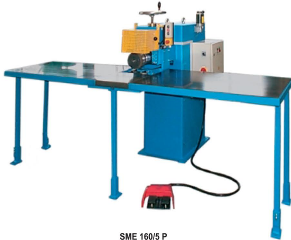
SME 160/5 P With manual feed and removable work table for long flat parts. Avec avance manuelle et plan de travail démontable pour pièces longues et plates.
