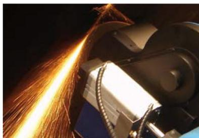
Il sistema pneumatico di avanzamento della testa molatrice, con sistema a compensazione, reagisce arretrando il pistone avanzamento in presenza di ovalità del pezzo e conseguentemente riduce il sovraccarico in asportazione materiale.
